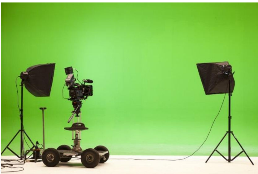
Abbildung 5: Kamerawagen und Beleuchtung vor einem Greenscreen
